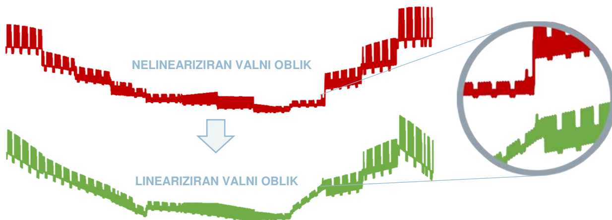
Slika 1.1-1 Primjer nelineariziranog i lineariziranog valnog oblika potrošnje električne energije
